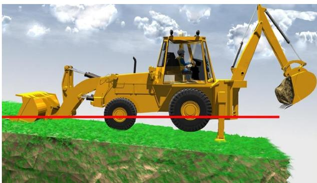
Si possible, vous devez positionner les stabilisateurs de manière à mettre le châssis à l'horizontal.
