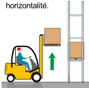
Avancez lentement en contrôlant l'insertion de la charge.
